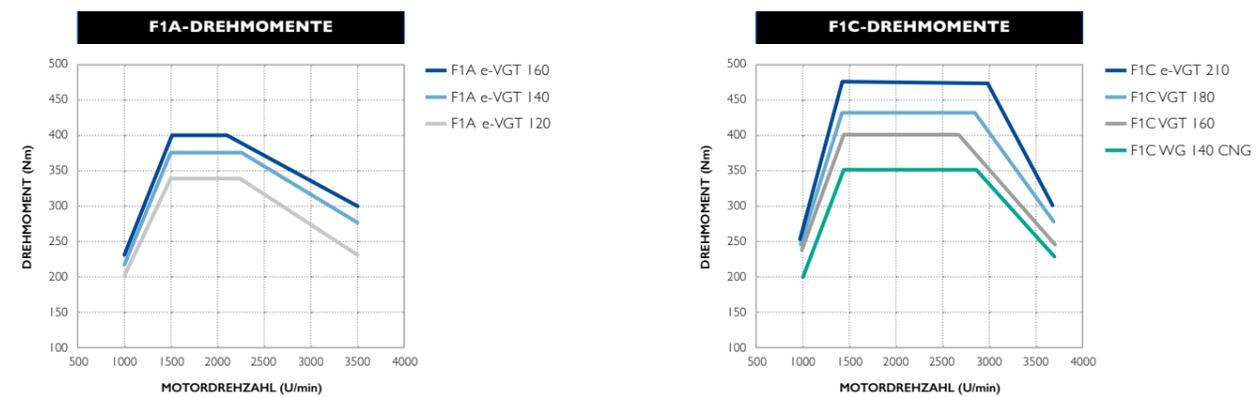
e-VGT: elektronisch gesteuerte variable Turbinengeometrie; VGT: variable Turbinengeometrie; WG: WasteGate Lader; CNG: Compressed Natural Gas - Komprimiertes Erdgas
